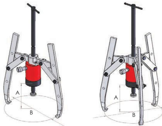
*Nota: Dimensiones calculadas con las patas del extractor en ángulo de 15° hacia afuera.*
